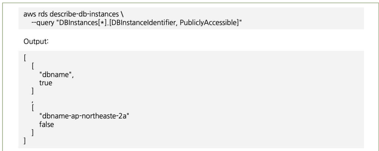
| 그림 2-2-17 | CLI - RDS 엔드포인트 퍼블릭 IP 할당 상태 확인
