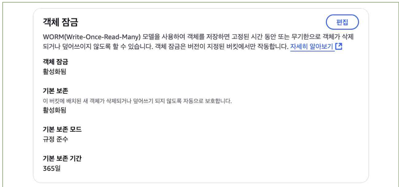
| 그림 8-2-1 | 행위 감사로그 저장 S3 버킷의 객체 잠금 설정 확인
